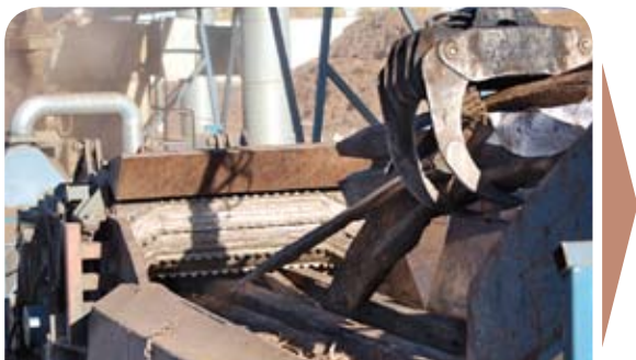
Slipers krossas i specialutvecklade fragmenteringskvarnar....
